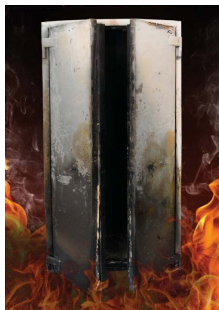
Реальний сейф Griffon FSL.195.2 після випробувань на вогнестійкість
